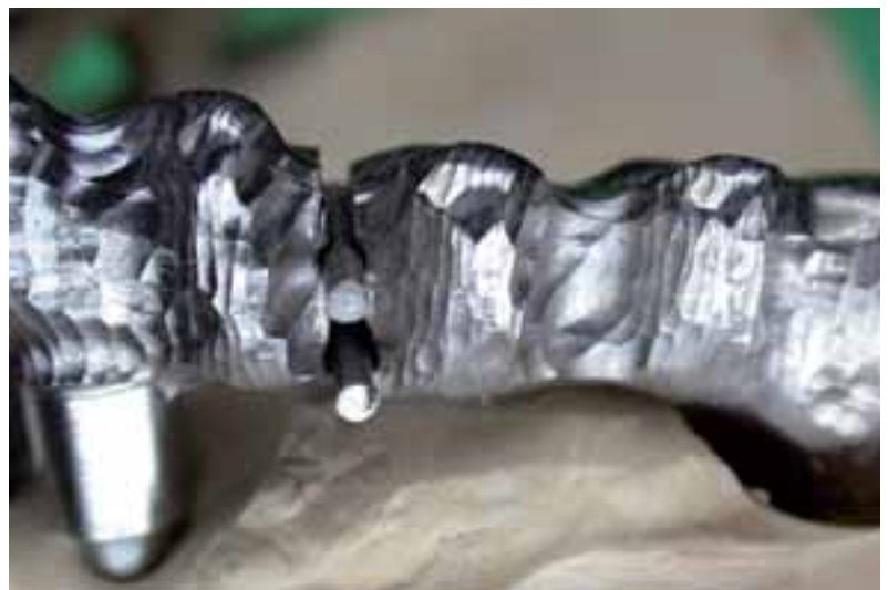
Abb. 31 Die beiden Drahtstifte sind eingesetzt. Da der Spalt breiter als hoch war, wurden die Löcher zur Aufnahme der Drahtstifte horizontal gebohrt.
