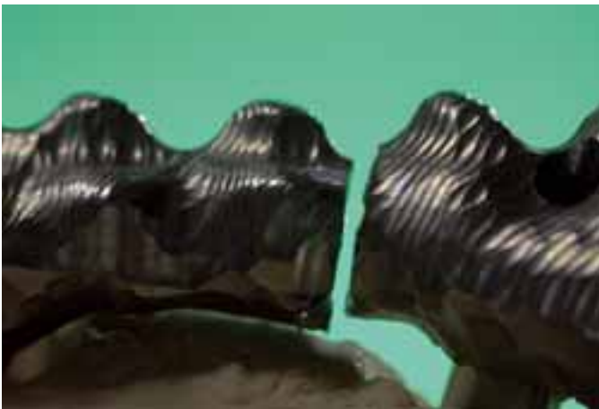
Abb. 29 Nach dem Schnitt war zwischen den beiden Teilen eine Stufe von mehr als einem Millimeter entstanden.
