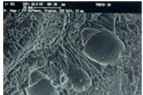
Abb. 5 Detaildarstellung von Probe Abb. 4 mit eichelförmigen Ausscheidungen, REM-Darstellung.
