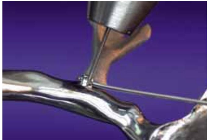
Abb. 6 und 7 Für Co-Cr-Schweißungen sind immer gezogene, kohlenstofffreie Drähte als Zusatzwerkstoff zu verwenden.
