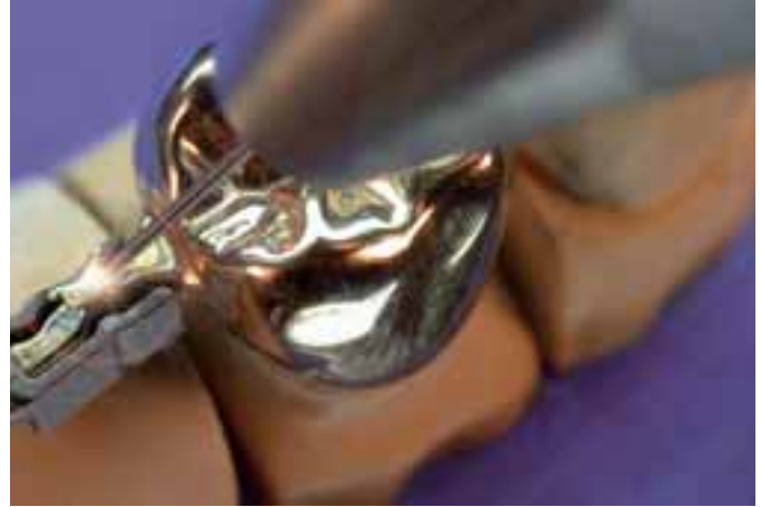
Abb. 9 Ein typischer Fall: Sekundärkrone an Modellguss. Die ersten Fixierimpulse werden in der Regel ohne Zulegematerial gesetzt.
