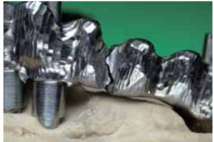
Abb. 35 Um die beiden Teile vollflächig verschweißen zu können, wird bukkal eine zirka 1-2 mm tiefe Rille gefräst.
