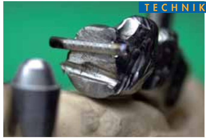
Abb. 32 und 33 Ein Draht wird in die untere Rille des einen Brückenelements geschweißt, während der andere Drahtstift in die obere Rille des anderen Schweißobjektes geschweißt wird.
