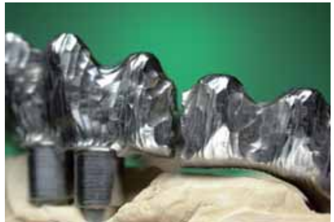
Abb. 30 Bevor die Löcher gebohrt werden, müssen die beiden zu verschweißenden Teile mit dem gleichen definierten Drehmoment auf das Modell geschraubt werden, wie es der Zahnarzt später im Mund des Patienten einsetzen wird.
