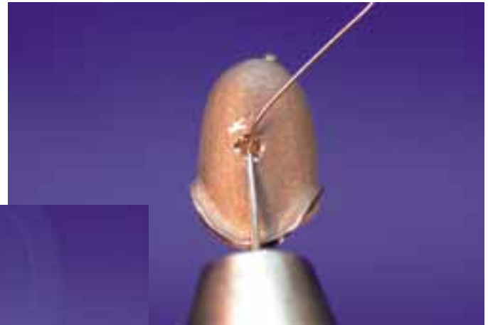
Abb. 2 Ein Loch in einer Krone aus einer goldreduzierten Legierung muss zugeschweißt werden. Der Schweißdraht wird je nach Situation in oder über das Loch gelegt.
