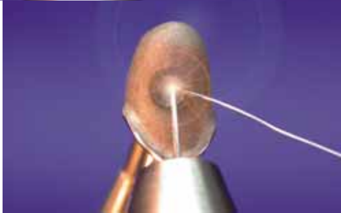
Abb. 2 Ein Loch in einer Krone aus einer goldreduzierten Legierung muss zugeschweißt werden. Der Schweißdraht wird je nach Situation in oder über das Loch gelegt.
