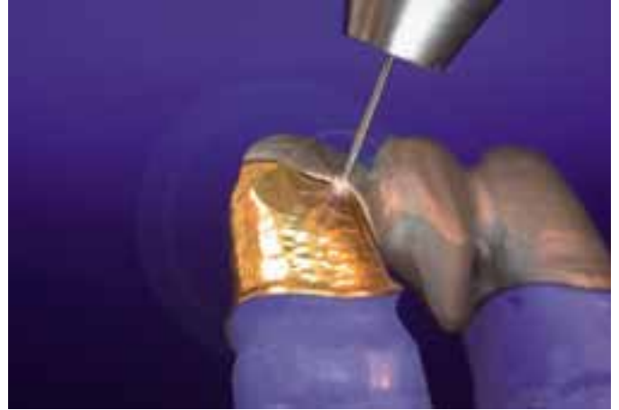
Abb. 12 Die ersten Schweißimpulse werden immer dort gesetzt, wo der Spalt zwischen dem Käppchen und dem Brückenelement am geringsten ist.
