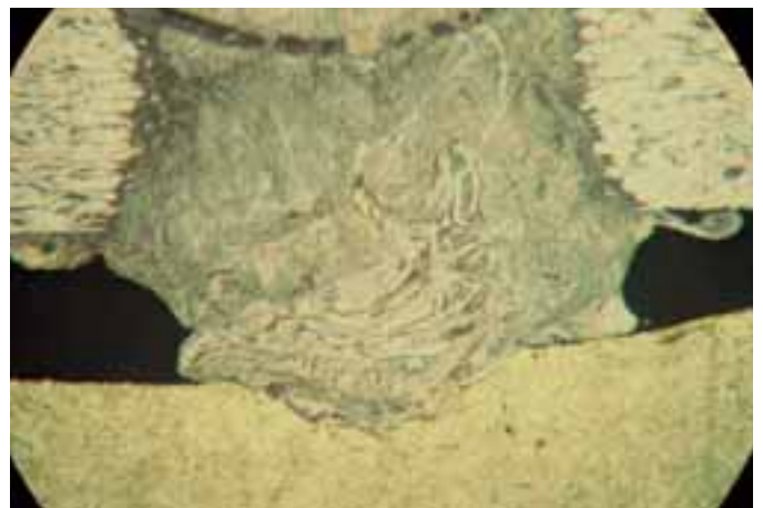
Abb. 16 Wenn korrekt geschweißt wurde, verschmilzt die gegossene Legierung sehr gut mit den Goldkäppchen (metallurgischer Schnitt, Hellfeld, 100x vergrößert).
