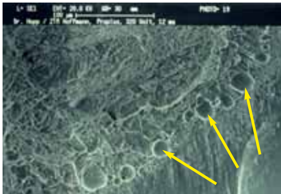
Abb. 4 Bruchbild durch die Laserschweißung einer Pd-Basis-Legierung. REM Darstellung.
