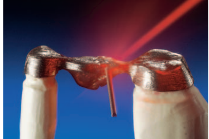
Abb. 8 Die Zugabe von artgleichem Material kann jederzeit erfolgen. Damit kann eine Kernzone immer weiter aufgebaut werden. Somit kann eine Laserschweißung unbegrenzt dick gemacht werden.
