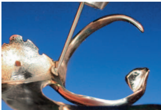
Abb. 14 Das Durchschweißen bis zu einer Tiefe von ca. 1,3 mm ist problemlos möglich.
