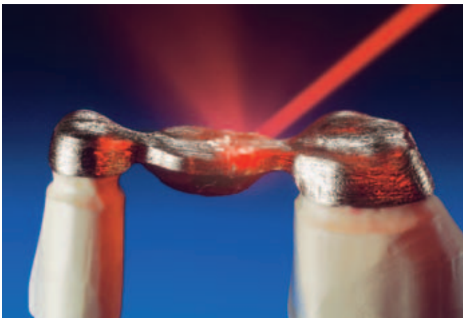
Abb. 9 Laserimpuls für Laserimpuls kann mit flüssigem Metall fast schon modelliert werden. Die Anzahl der Impulse soll immer der Aufgabe entsprechen. Grundsätzlich ist geringere Leistung bei mehr Impulsen immer Material schonender als weniger Impulse bei höherer Energie.
