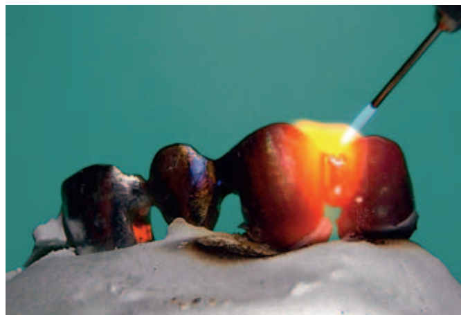
Abb. 4 Die korrekte Flammeneinstellung: Das Lot schießt in die Lotfuge.
