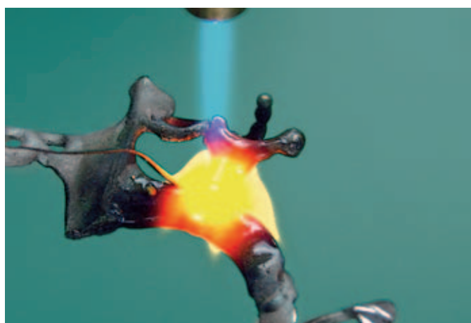
Abb. 5 Große Objekte müssen gleichmäßig durchwärmt werden. Die Brennerauswahl ist hierbei wichtig.
