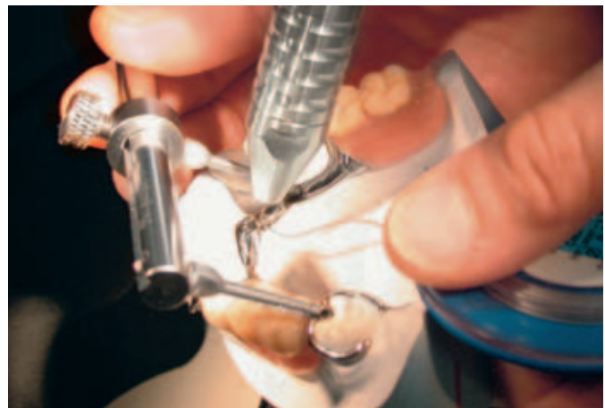
Abb. 18 Das Schweißen beginnt mit dem Fixieren auf dem Modell. Erst wenn der fixierte Modellguss auf dem Modell perfekt sitzt, kann richtig geschweißt werden.
