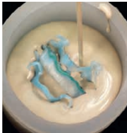
Abb. 12 bis 14 Das Eingießen der Einbettmasse kann problemlos unter Sichtkontrolle erfolgen.
