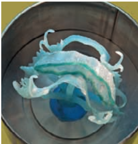
Abb. 9 Sowohl für die Metallringe als auch für die muffelfreie Gusstechnik bekommt man die Silikonform in allen Größen in eine einzige Grundplatte.
