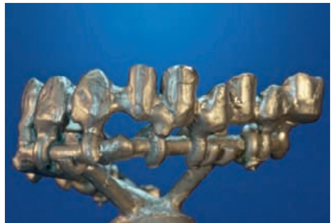
Abb. 22 bis 24 Die Einbettungsexpansion mit maruvest-Speed-Einbettmasse für den Speed-Guss wird mit ca. 95 % Liquid auf NEM-Gerüste eingestellt.
