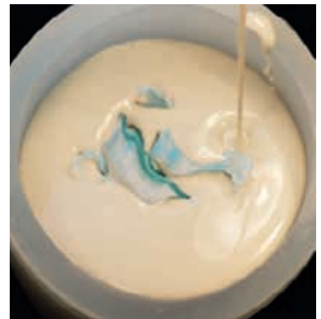
Abb. 11 Bei der Speed-Gusstechnik mit der speziellen Einbettmasse maruvest Speed kann für alle Metalllegierungen der Expansionswert perfekt eingestellt werden. Für Modellgüsse verwendet der Autor eine Konzentration von ca. 98 % Liquid, um die Expansion einzustellen.
