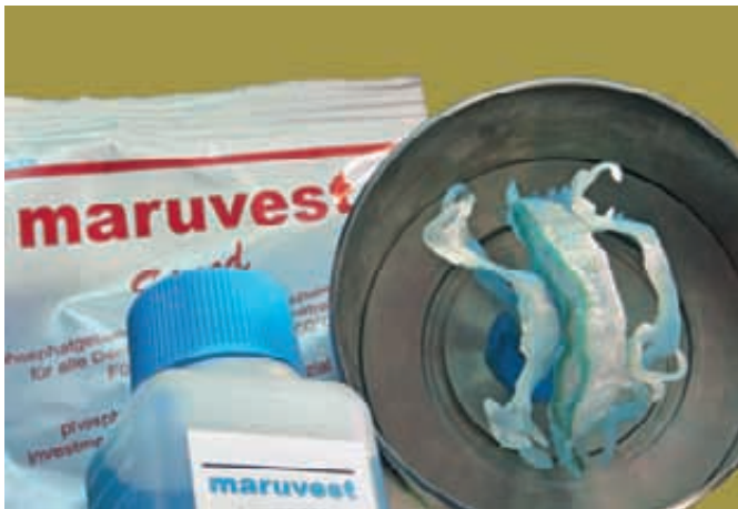
Abb. 22 bis 24 Die Einbettungsexpansion mit maruvest-Speed-Einbettmasse für den Speed-Guss wird mit ca. 95 % Liquid auf NEM-Gerüste eingestellt.
