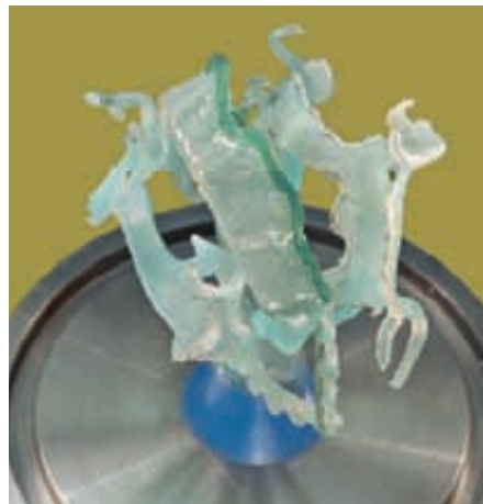
Abb. 10 Mehrere Modellgussgerüste können in einer Muffel angestiftet werden.
