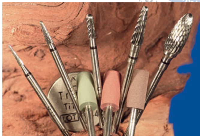
Abb. 3 Spezielle Instrumente für die Ausarbeitung von Titan. Die GTi (Grobe Titanbearbeitung) erfolgt mit Fräsern von der Firma Gebr. Brasseler, Lemgo, die speziell für Titan entwickelt wurden. Sie leisten einen entscheidenden Beitrag zur Überwindung der Bearbeitungsprobleme.
