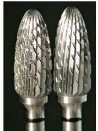
Abb. 13 Fräsen, die mit Druck eingesetzt werden, sind schnell mit Titan verschmiert und bringen keinen Erfolg. Links: Eine mit Titanspänen zugesetzte Fräse. Rechts: Bei richtigem Einsatz bleibt die Fräse sauber.
