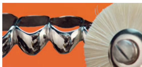
Abb. 17 Aufwändiger ist die Politur des Werkstücks: Zunächst wird immer feiner gummiert und dann mit dem Handstück und einer Bürste mit Titanpolierpaste auf Hochglanz gebracht.
