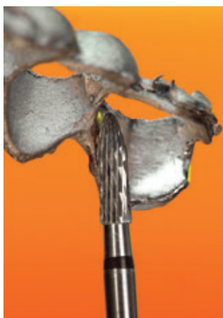
Abb. 14 Die Ausarbeitung mit niedriger Drehzahl und fast ohne Druck, das ist die Kunst beim Titan. So ist der Abtrag mit den Titanbohrern butterweich.
