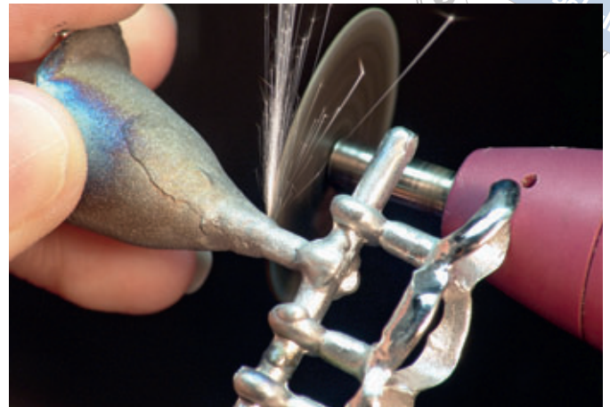
Abb. 12 Die Schnitttechnik zeigt den Umwandlungsprozess von Titan zu Titanoxid auf. Jeder Funke ist als sichtbare Oxidation mit Luftsauerstoff zu erkennen.
