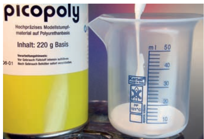
Abb. 1 Picopoly ist ein Zwei-Komponenten-Modellstumpfmateriale auf Polyurethanbasis.
