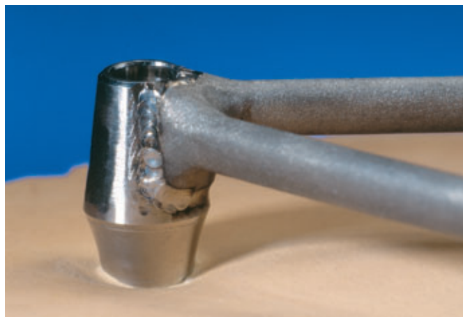
Abb. 15 Eine ausreichend stabile Verbindungstechnologie muss in der Lage sein, die auf sie wirkenden Kräfte schadlos zu überstehen.
