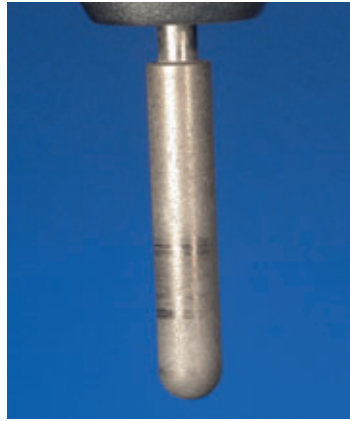
Abb. 16 Nach kurzzeitigem falschem Einsatz des Diamantschleifers ist die Diamantfläche zirkulär aus dem Schaft herausgeschlagen bzw. ist das Diamantkorn durch die Zentrifugalkraft aus dem Bindemittel gerissen.
