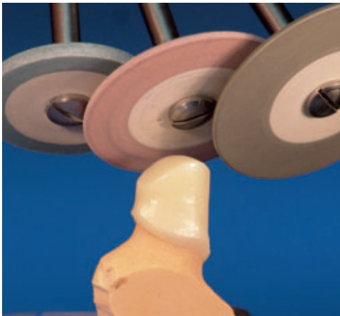
Abb. 3 Ebenfalls in drei Stufen grob (blau), mittel (rot) und fein (grau) sind die diamantierten Schleifscheiben bei den Diamanten in einer dauerelastischen Bindung eingebettet und für die Bearbeitung von Zirkoniumdioxid sehr gut geeignet. Hiermit lassen sich speziell Ränder ausdünnen und Polituren auf den Oberflächen durchführen.
