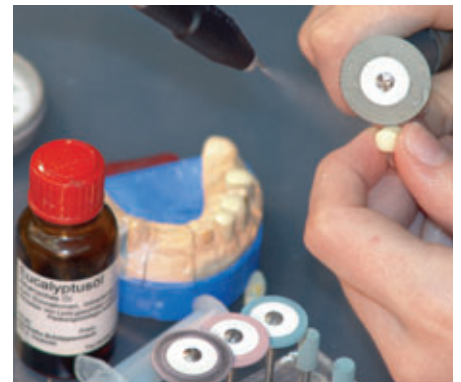
Abb. 23 Das Ausdünnen und Gummieren von ZrO_2 -Rändern und Flächen erfolgt mithilfe von diamantierten Gummipolierern, die ebenfalls während des Schleifzyklus in einem Spraynebel abgekühlt werden.
