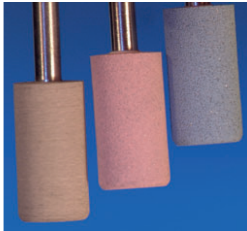
Abb. 4 Diese Schleifkörper (grau = Hochglanzgummierer, rot = mittlere Körnung, blau = grobe Körnung) sind ebenfalls als Gummipolierer gut geeignet, um parallele Flächen für die Geschiebetechnik in der abschließenden Oberflächenpolitur zu bearbeiten. Die Abnutzung dieser Bohrer muss an einem Abrichtstein immer wieder auf die passende Oberflächenkontur überprüft und eingestellt werden.
