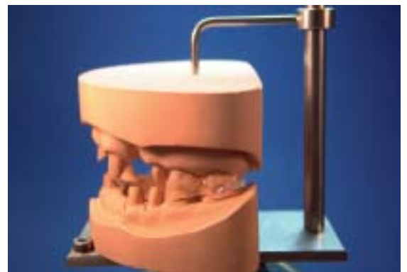
Abb. 7 und 8 Da das zu verklebende Modellpaar fixiert ist, kann der Klebstoff ohne Störung aushärten.
