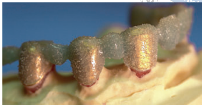
Abb. 22 Die fertige Modellation wird mithilfe von MetaBlue (Primotec), einem lichthärtenden, ausbrennbaren Kunststoff, eingestrichen und kann dann mit Retentionsperlen benetzt werden.
