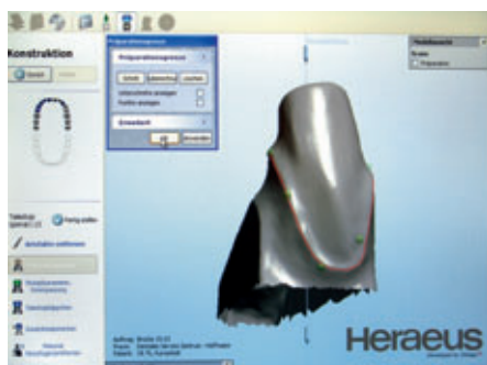
Abb. 4 Mit dem Scanner 3shape (3shape, Kopenhagen, Dänemark) und der passenden Software lassen sich die Konstruktionen der Teleskope am Rechner durchführen. Diese Daten werden anschließend ins Schleifzentrum zu der Firma Heraeus Kulzer, Hanau, geschickt.
