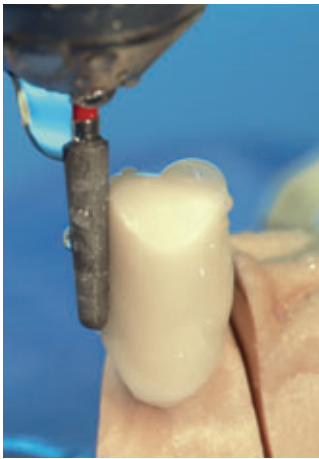
Abb. 9 Zum Fräsen wird das Original-Sägmodell benutzt, mit den geeigneten Instrumenten (Brasseler) mit unterschiedlicher Körnung kann die Oberfläche perfekt additiv nachgeschliffen werden.
