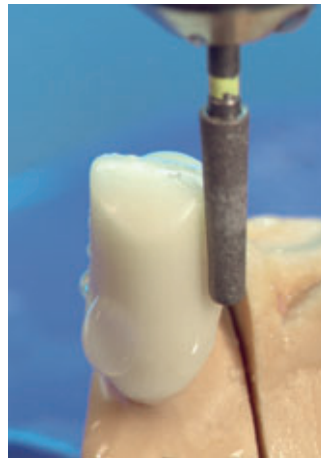
Abb. 10 Mit einer Rautiefe von 8 µm wird das Schleifen der parallelwandigen Teleskopflächen beendet.
