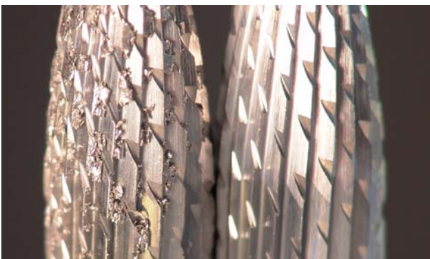
Abb. 3: Der linke Fräser zeigt eindeutige Schneidenausbrüche und Titanspäne, die bereits durch die einmalige falsche Benutzung entstanden sind.
