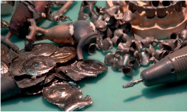
Abb. 1: Durch die richtige Verarbeitungstechnik und den Einsatz geeigneter Werkzeuge wird die Titanbearbeitung vereinfacht.
