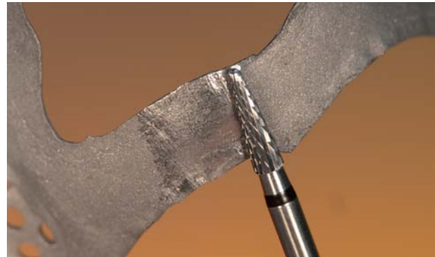
Abb. 11: Das Glätten der Oberfläche mit einem GTI-Hartmetallfräser erfolgt drucklos mit niedriger Drehzahl.
