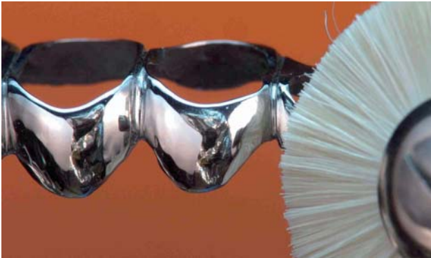
Abb. 14: Die Oberflächenpolitur mit speziellen Titan-Diamantpolierpasten erfolgt ebenfalls drucklos.
