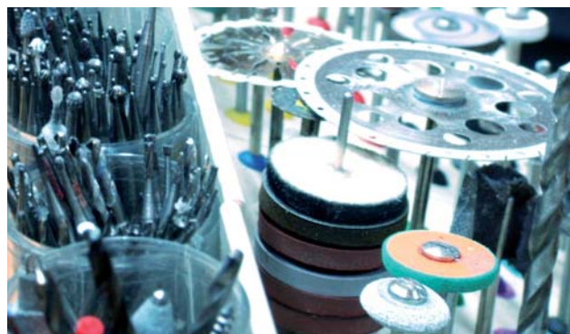
Abb. 7: Nicht alles was sich dreht, sollte für die Titanbearbeitung benutzt werden.
