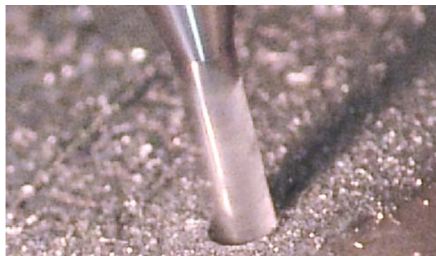
Abb. 6: Eine gute Luftkühlung mittels Pressluft verhindert zu hohe Temperaturen.
