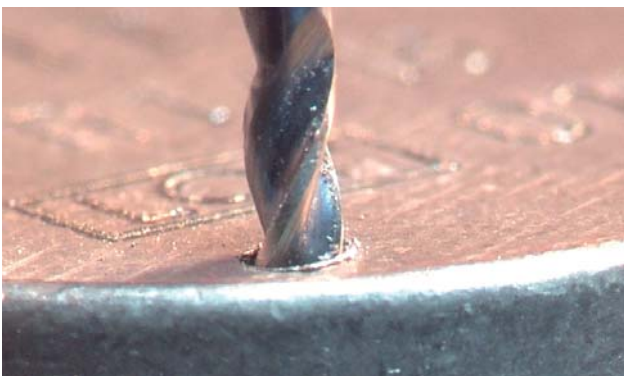
Abb. 4: Die Bohrung mit einem Spiralbohrer im Fräsgerät erfolgt zügig, wobei der Spiralbohrer immer wieder angehoben wird, um die Schnittspäne aus der Bohrung zu transportieren.
