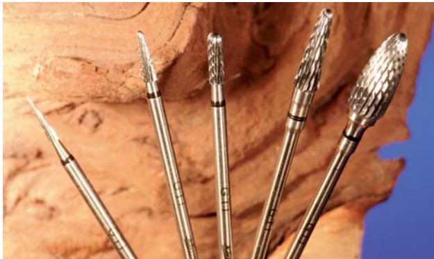
Abb. 10: Spezielle GTI-Fräser (Grobe Titanbearbeitung) der Firma Gebr. Brasseler wurden eigens für den Werkstoff Titan entwickelt und bringen entscheidende Vorteile bei der Bearbeitung.
