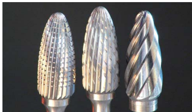
Abb. 9: Die Schneidgeometrie der Werkzeuge ist sehr aggressiv. Der Fräswinkel ist bei diesen Werkzeugen ideal gestaltet. Diese Fräser waren ursprünglich für andere Werkstoffe entwickelt worden, eignen sich jedoch hervorragend für die Titanbearbeitung.
