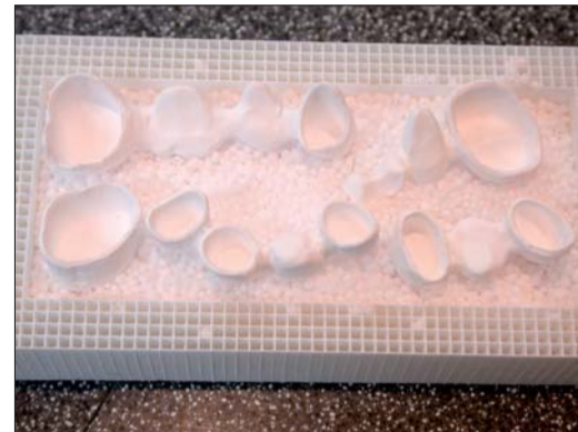
Im Sinterofen (Cercon heat) schrumpfen die Restaurationen auf die Dimensionen der Modell- bzw. Mundsituation und erhalten dabei ihre endgültige Härte und Festigkeit.
